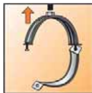
1. Навинтить хомут на шпильку и открыть его.
