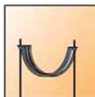
1. Смонтировать нижнюю половину хомута на шпильки.
